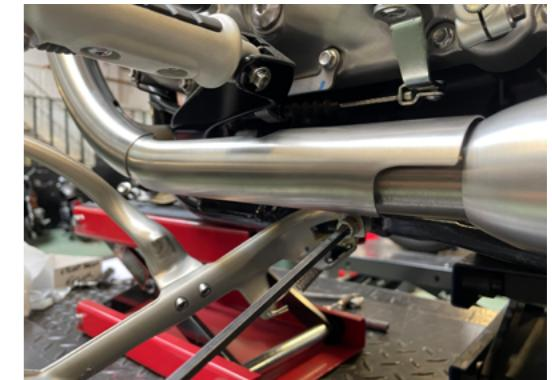
8 - Installer la butée de béquille en caoutchouc (à l'aide d'un tournevis plat) sur son support puis la fixer entre la béquille et son levier.
