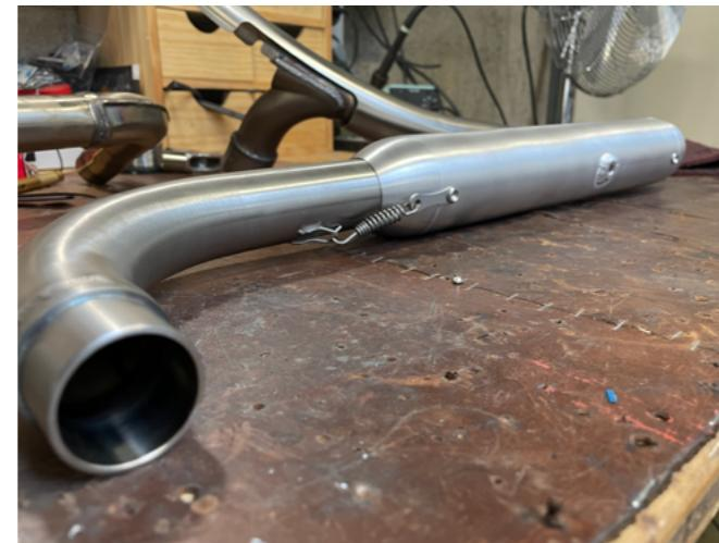
4 - Installer les platines de support de silencieux en lieu et place des supports d'origine. Récupérer la vis d'origine M8. Mettre la vis bombées dans le trou oblong en traversant le cadre, visser l'écrou freiné sans serrer.
