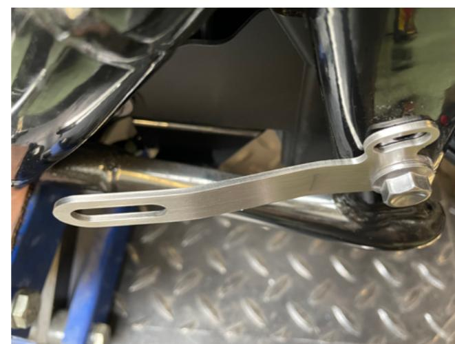
5 - Ré-Installer sur le catalyseur les colliers de serrage + joints + supports, rendre accessible l'écrou de 10 des colliers. Serrer à la main l'écrou.
