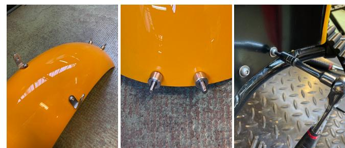
4 - Visser sans serrer les deux vis des pattes sur le cadre. Celle de droite doit être montée en intercalant une entretoise entre la patte et le cadre.
