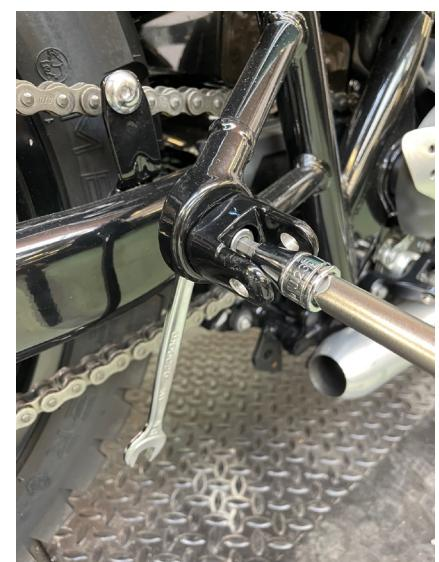
Avec les écrous fournis, installer le support arrière sur la fixation du cale-pied et le support avant sur la fixation moteur. (le support avant possède la vis la plus longue)
