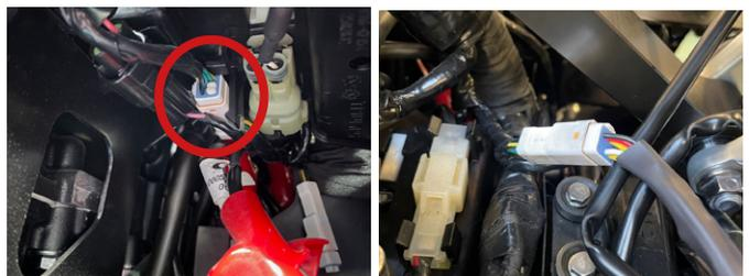
4 - Brancher les cables comme sur les photos, la couleur des fils pouvant varier, se référer au manuel fourni par Highsider en cas de doute.
